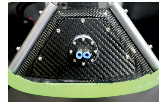
Filzstreifen auf Tank kleben und Tankblende mit 5x Linsenkopfschraube M3x8 befestigen.
