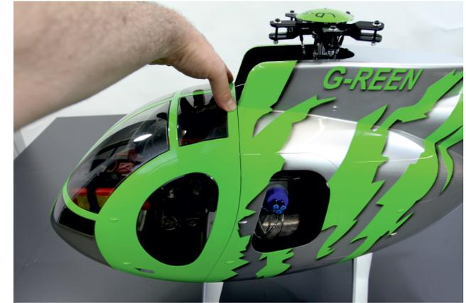
Frontteil mit den unteren Stiften zuerst ansetzen und oben am Steg leicht nach unten drücken. Frontteil wird durch Magnete herangezogen.
