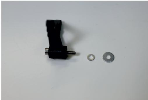
Umlenkhebel mit 4x ISK M3x25 , 4x Distanz 1mm und 4x U-Scheibe montieren. Reihenfolge beachten !
