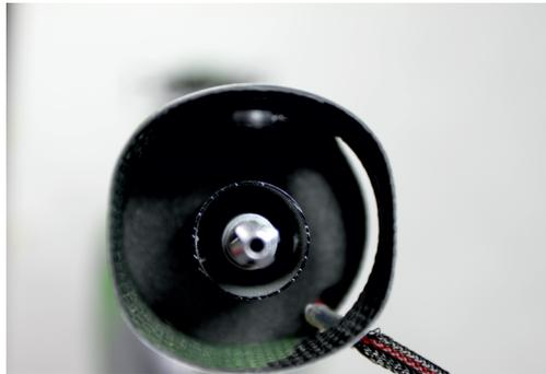
Schaumstoff-Spant von hinten in den Rumpf schieben. Schaumstoff-Spant später mit Epoxy-Kleber geben verschieben sichern.
