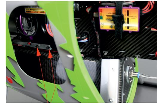
Mechanik hinten mit originalen Schrauben befestigen.
