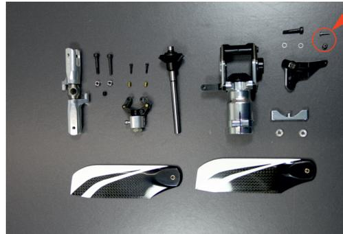
Linsenkopfschraube M 2x8 und Kugel 2mm .
