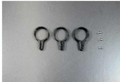
Führung für Heckanlenkung gemäß Bild positionieren und mit selbstschneidende Schraube 2,2x6 befestigen.
