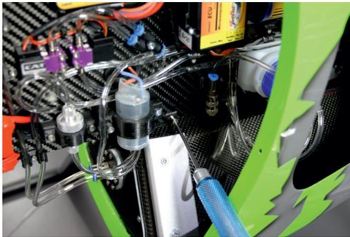
Mechanik vorne mit 2x ISK Schraube M3x10 befestigen.
