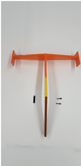
Rumpf mit 2x ISK Linsenkopfschraube M3x8 und 2x U-Scheibe 3,2x7 befestigen. Anschließend die vier ISK Linsenkopfschrauben vom Halter fest schrauben.
