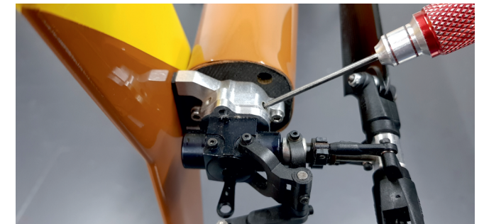
Die drei Madenschrauben M4x4 leicht anziehen.
