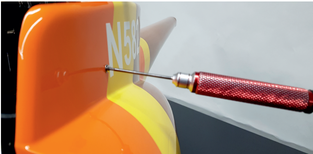
Rumpf mit 2x ISK Linsenkopfschraube M3x8 und 2x U-Scheibe 3,2x7 befestigen. Anschließend die vier ISK Linsenkopfschrauben vom Halter fest schrauben.
