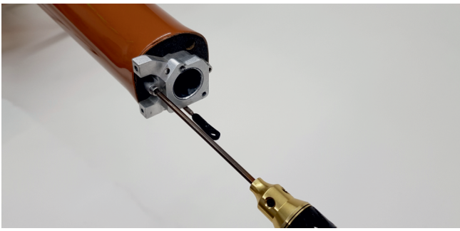
Heckrotorhalter mit 2x ISK Schraube M3x14 montieren
