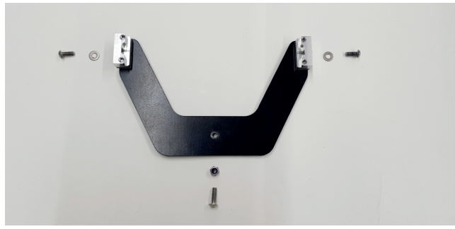
Halter für Rumpfbefestigung oben mit 1x ISK Linsenkopfschraube M3x10 und M3 Stop Mutter an der Mechanik befestigen.
