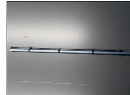
3x Teflonführung für Heckrotoranlenkung auf ca.10mm zuschneiden und auf den Cfk Stab 2mm schieben.
