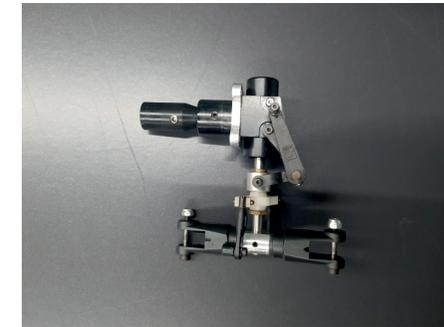
Kürzere Kardanglocke mit 2x Madenschraube M4x5 an Mechanik befestigen
